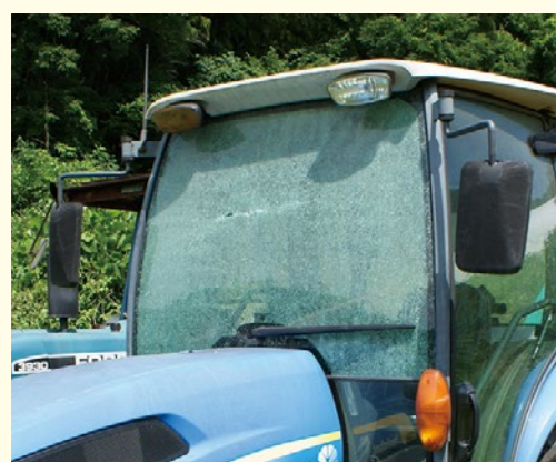
飛び石によるフロントガラスの損傷
